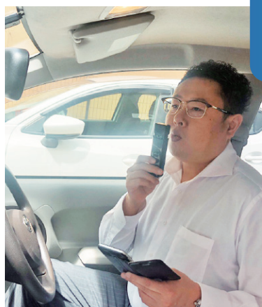
運転者は乗車前後にKIBACOに連動した検知器でアルコールチェックを行う。数値が基準値を超えていた場合は管理者画面にアラート通知が表示される
